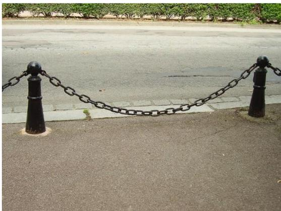
Figura 3. Andamento a catenaria di una catena sospesa.
